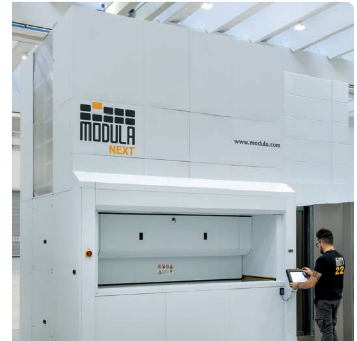
DIMENSIONI DELLA FINESTRA DI PICKING (da 100 x 100 mm a 2.500 x 654 mm) CONFIGURABILE DA SOFTWARE WMS
